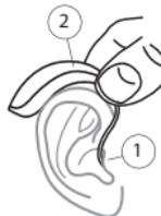
1. Insérez le système de maintien auriculaire dans l'oreille tout en tenant la partie basse du tube/fil écouteur. Pour ce faire, il est conseillé de tirer dans le même temps l'oreille externe vers le haut et vers l'arrière.
