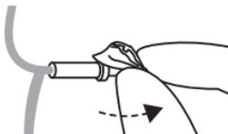
3. Vérifiez que le dôme tulipe est solidement fixé en soulevant la partie inférieure du dôme et en vérifiant que la partie centrale recouvre entièrement l'extrémité nervurée.
